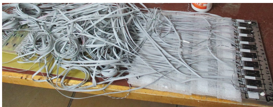
Рис. 8: Подготовка стенда для аттестации термодатчиков.
