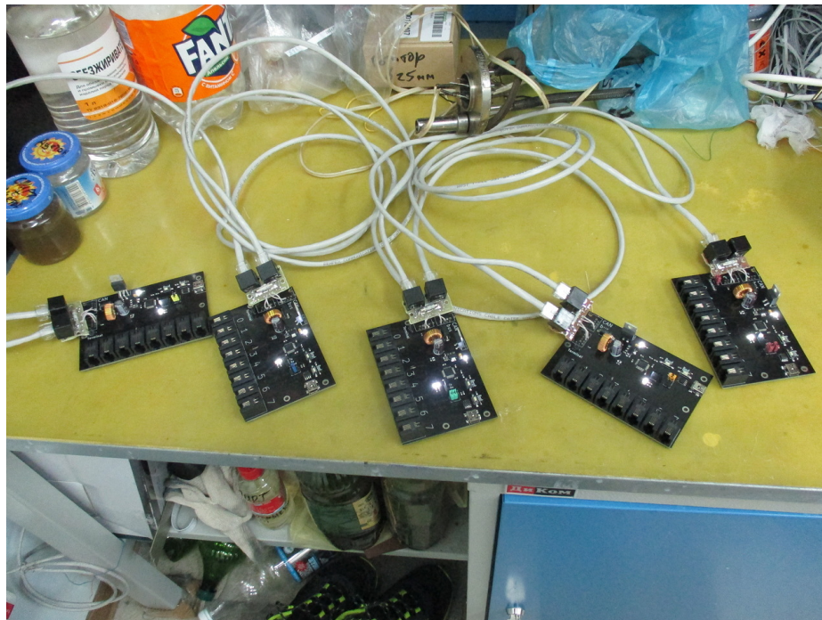
Рис. 7: Термоконтроллеры в сборе на CAN-шине.
