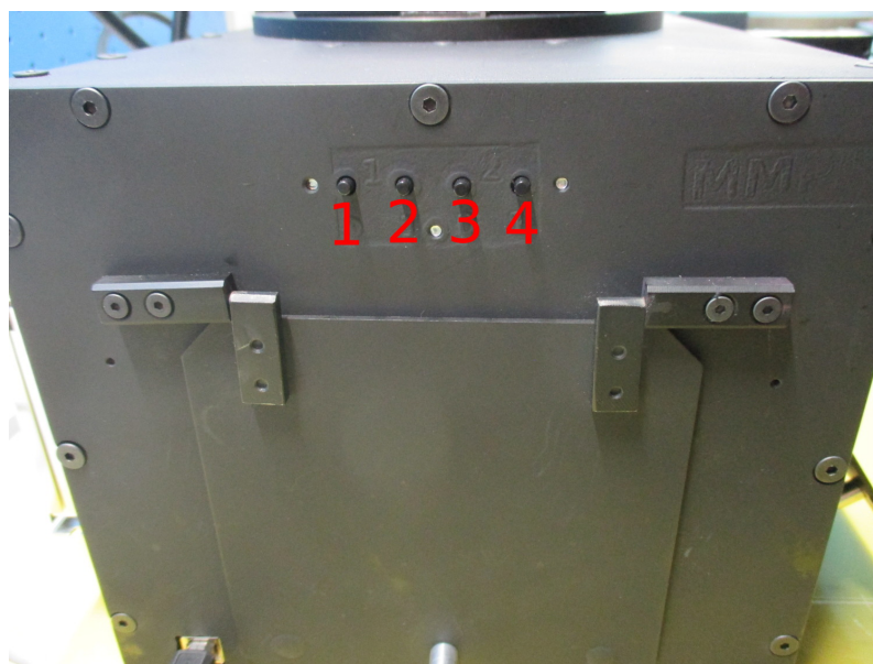
Рис. 8: Кнопки ручного управления механизмом линейных трансляторов: 1 и 2 — перемещение транслятора анализатора поляризации в отрицательном и положительном направлении, соответственно; 3 и 4 — аналогичные перемещения транслятора фазовой пластины.
