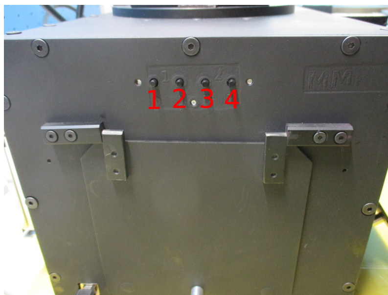
Рис. 5: Кнопки ручного управления механизмом линейных трансляторов: 1 и 2 – перемещение транслятора анализатора поляризации в отрицательном и положительном направлении, соответственно; 3 и 4 – аналогичные перемещения транслятора фазовой пластины.
