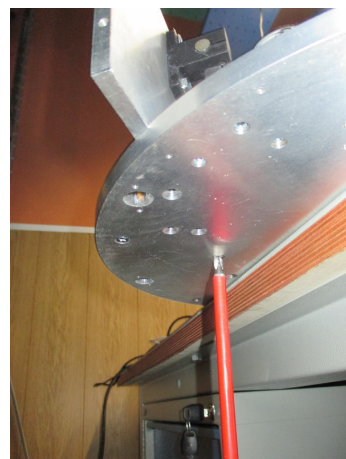
Рис. 22: Снятие стоек с креплением элементов линейного транслятора анализатора поляризации.
