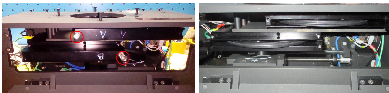
Рис. 4: Крышки турелей. На рис. слева отмечено положение винтов, фиксирующих крышки. На рис. справа — турели с открытыми крышками.
